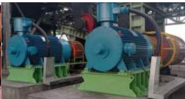
日照港口 355kW 双驱风冷高压皮带机永磁电机
